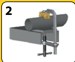
TRUBKA S použitím podložky V-PAD pro snadné upnutí trubek, jeklů a dalších profilů.
