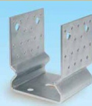
Profil U - široký žárový zinek, tloušťka profilu 4 mm, výška 150 mm
